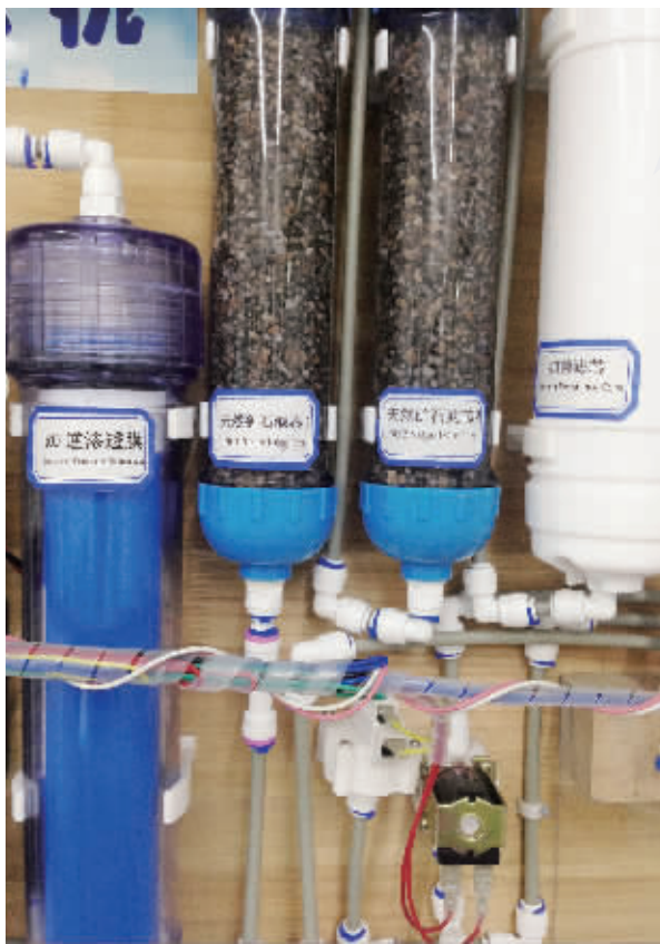
“人工山泉水直饮机”内部结构图。销售人员称，与普通净水器比较，这款贵了近一倍的机器在内部加装了两管矿石滤芯。
