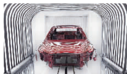
▲东风日产襄阳工厂涂装车间内,英菲尼迪正接受内饰线斑马灯检查。
