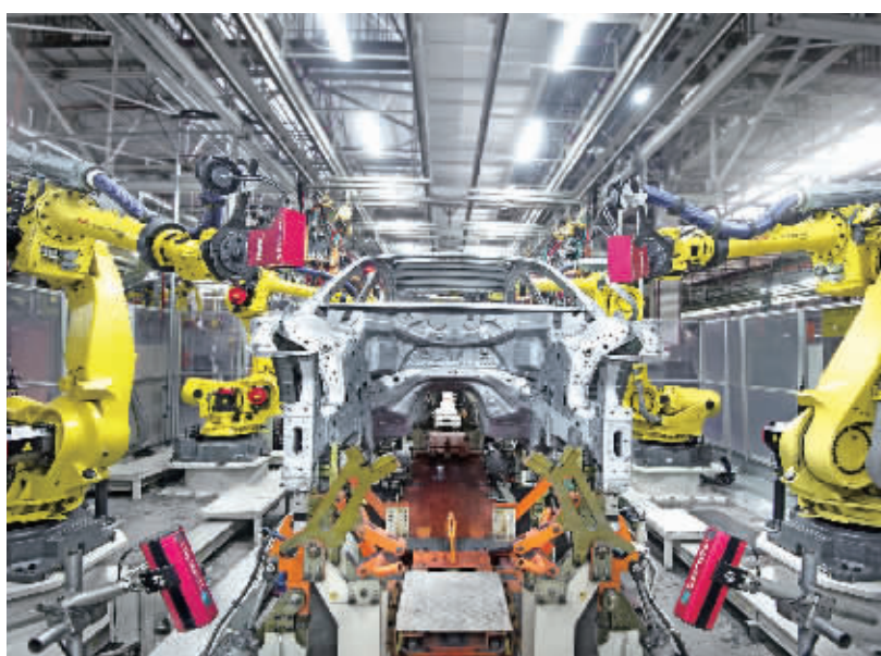
▲英菲尼迪车型引进的激光测量仪,能快速对车体进行在线测量。
