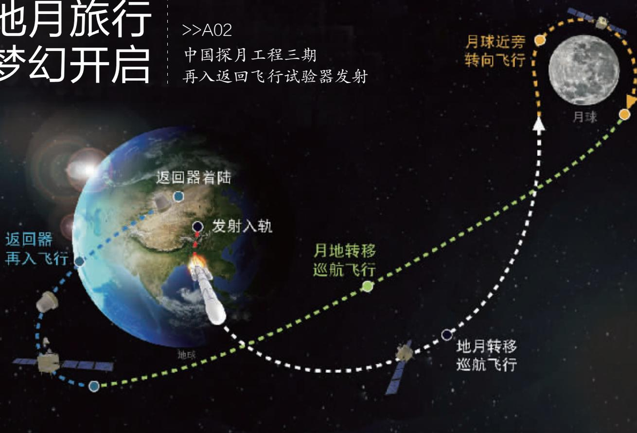
探月工程三期再入返回飞行试验路线图。 新华社图
