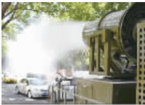
@央视新闻:7月30日,一辆酷似“大炮”的庞然大物出现在重庆九龙坡区公路上。这是用来降尘降温的新型喷水车,能装5吨水,可连续工作5小时,“炮筒”还能360度随意旋转,最远能喷水到100米。
