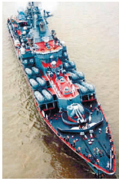
“光荣级”最引人注目的是舰艏两舷的8座双联装SS-N-12反舰导弹发射装置。
