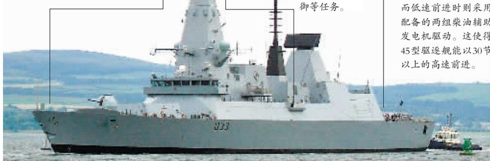
第一批3艘45型驱逐舰配备了6组八联装的Sylver A-50垂直发射器,而第二批3艘则配备了8组八联装的MK-41垂直发射系统。这些导弹发射系统,可配置性能优异的紫苑防空导弹(英国又称其为海毒蛇)以及战斧巡航导弹、VLA反潜火箭等,既可以防空,又可以对陆地攻击,还能反潜,可谓海上多面手。45型还装备了一门MK-8型113毫米舰炮,具有隐身炮塔。
