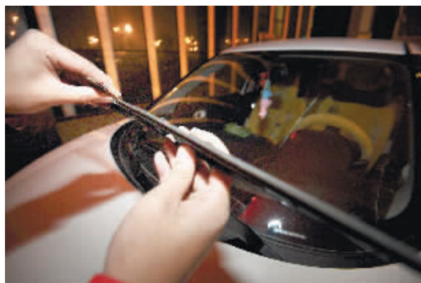
小小的磨砂纸，就可将雨刮器打磨得更加平滑。11月20日，记者验证了这一小窍门。 记者 李丹 摄
