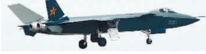
歼-20是成飞研制的新一代双发重型隐形战机。歼-20的机头、机身呈菱形，垂直尾翼向外倾斜，起落架舱门采用锯齿边设计，具隐形战斗机特征。该机外形具有低可探测设计，但是尾喷口的隐身处理不及F-22，而与F-35类似采用了锯齿处理。
