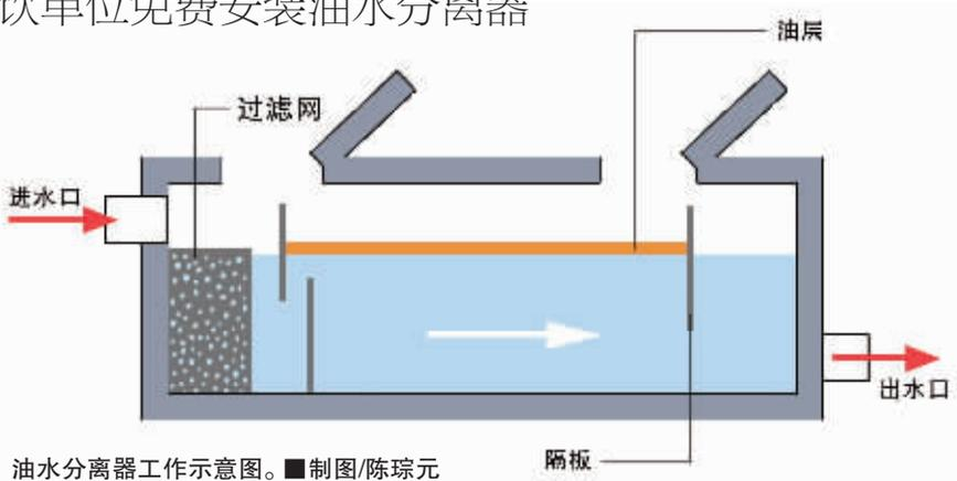
油水分离器工作示意图。■制图/陈琼元
