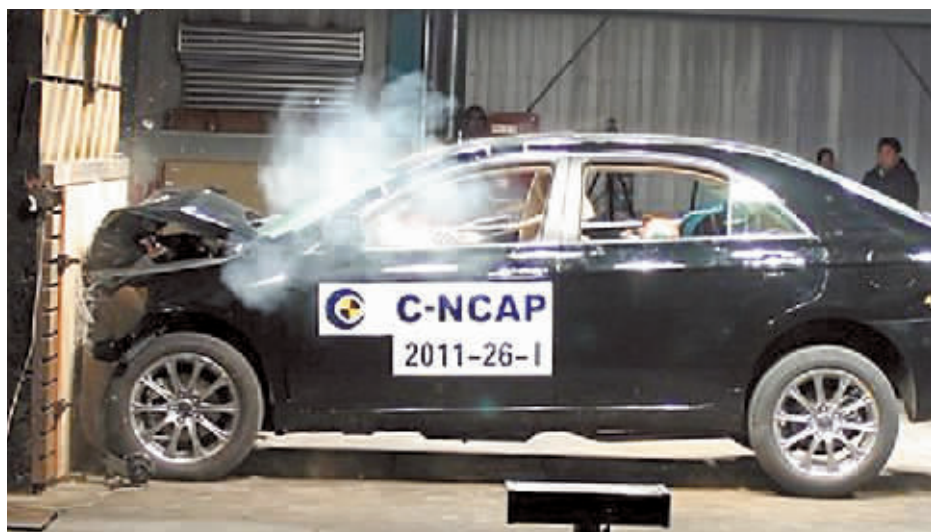
帝豪EC8正在进行正面100%重叠刚性壁障碰撞试验。
