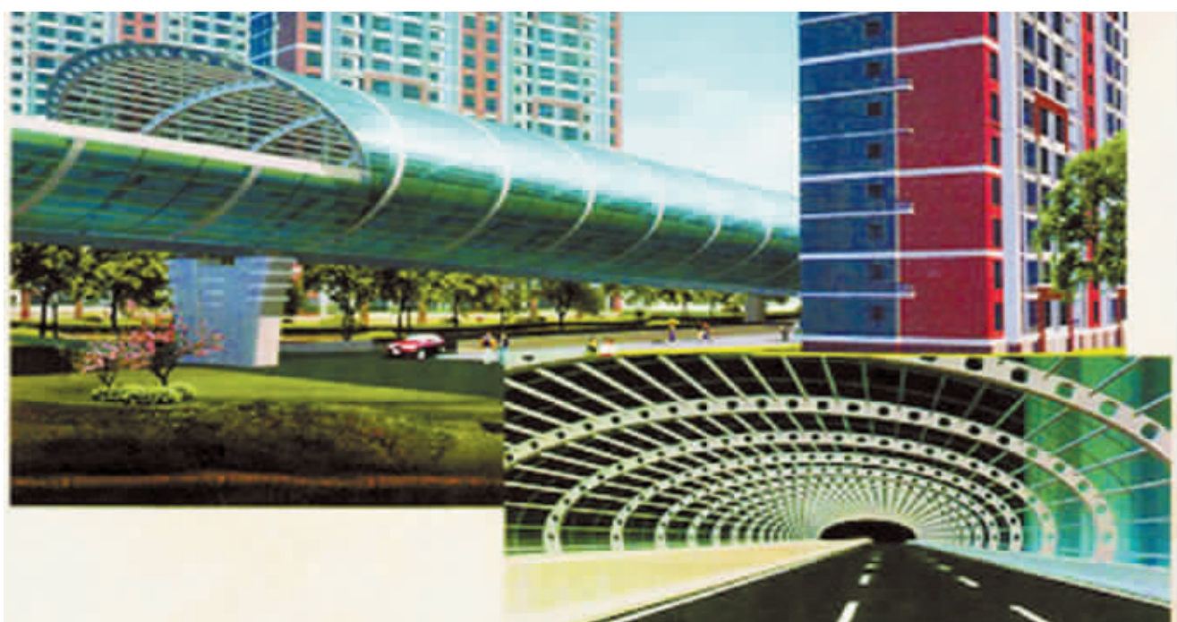
为了减少噪声影响,大桥在穿越湘江世纪城购物中心1栋与悦江苑15栋之间时将设置全封闭隔音罩。(效果图)
