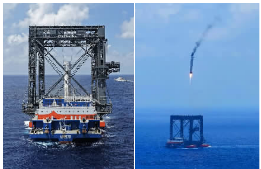
左图:海上回收平台通过网系捕获方式成功回收长征十号乙运载火箭一子级。右图:长征十号乙运载火箭在海南商业航天发射场发射升空,成功将卫星送入预定轨道,火箭一子级成功回收,任务取得圆满成功。 新华社 图
