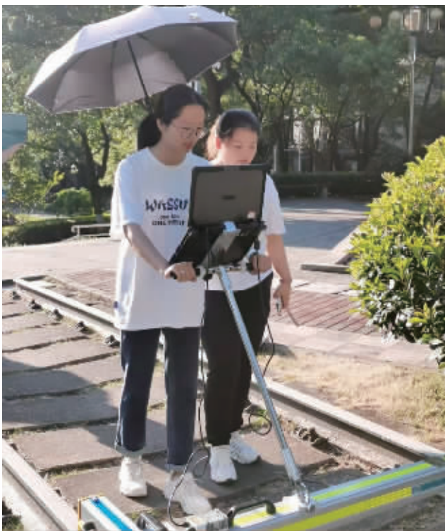
楼婉婷(左)在中南大学轨道基地使用轨检仪进行轨道几何状态检测。 受访者 供图
