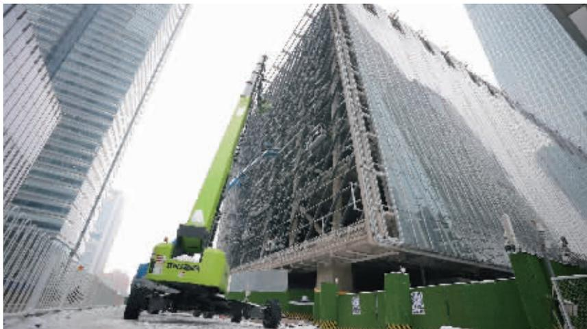
72米级自行式直臂高空作业平台 ZT72J-V。中联重科智能高机供图
