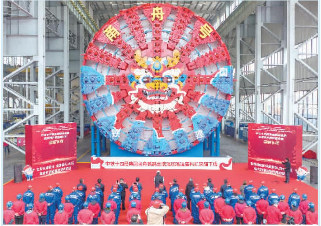
2月26日上午，一台刀盘涂装“瑞龙”图案的超大直径盾构机“甬舟号”在长沙正式下线。将应用于世界上最长海底高铁隧道——宁波至舟山铁路金塘海底隧道施工。 湖南日报全媒体记者 李健 通讯员 刘福昌 摄影报道
