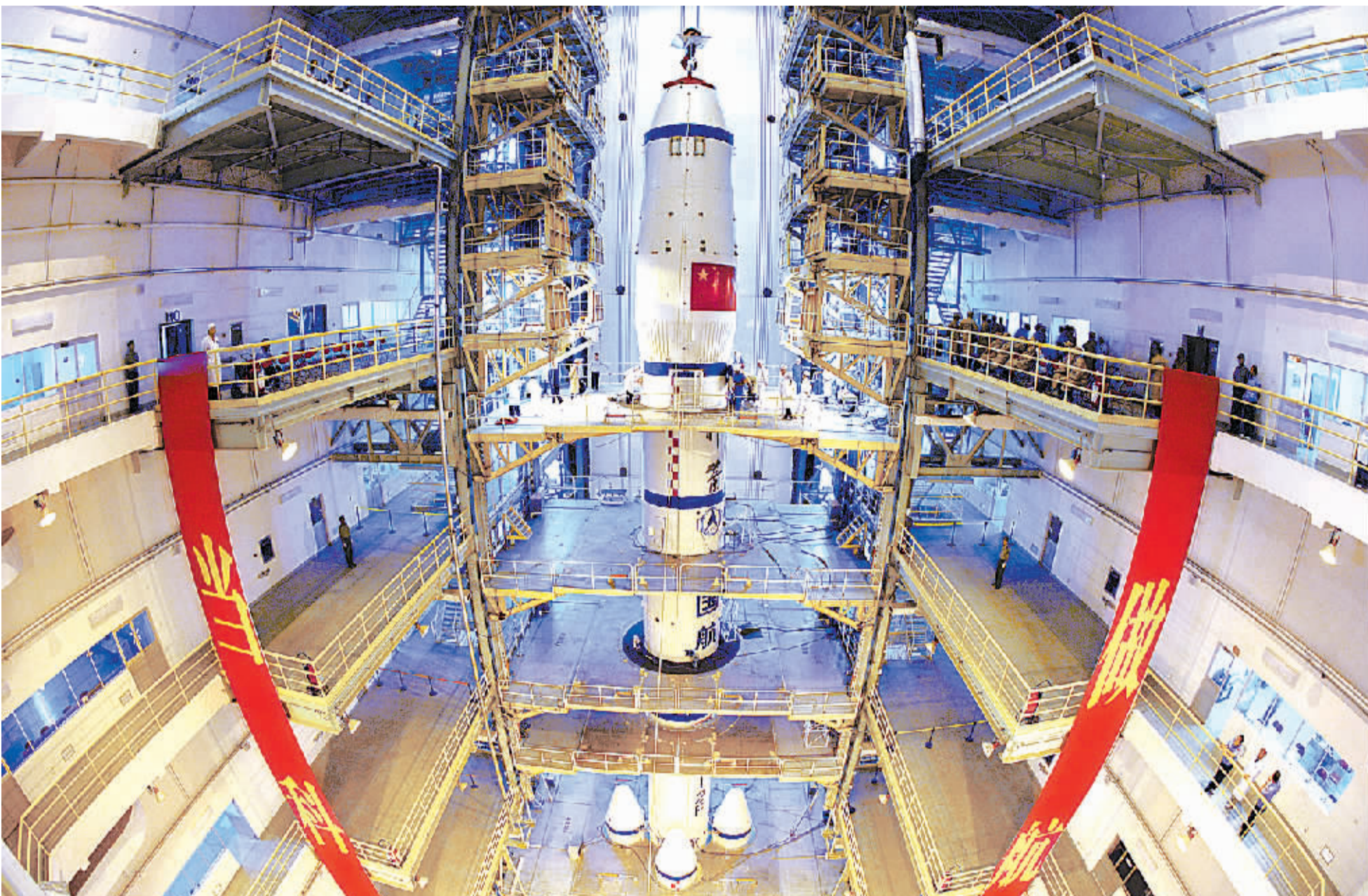
图为神舟七号飞船与长征二号F运载火箭在垂直装配厂房进行对接。
