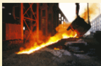
公司30MVA 锰硅合金电炉
