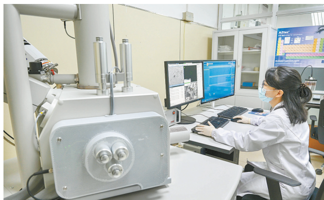
5月13日,文物科技保护中心仪器分析室,文物修复员运用扫描电镜-能谱仪对长沙窑瓷片样品进行检测分析。
