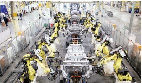
产业数字化催生技术革命。图为北汽株洲基地焊装车间工作的机器人。 黄进 摄
