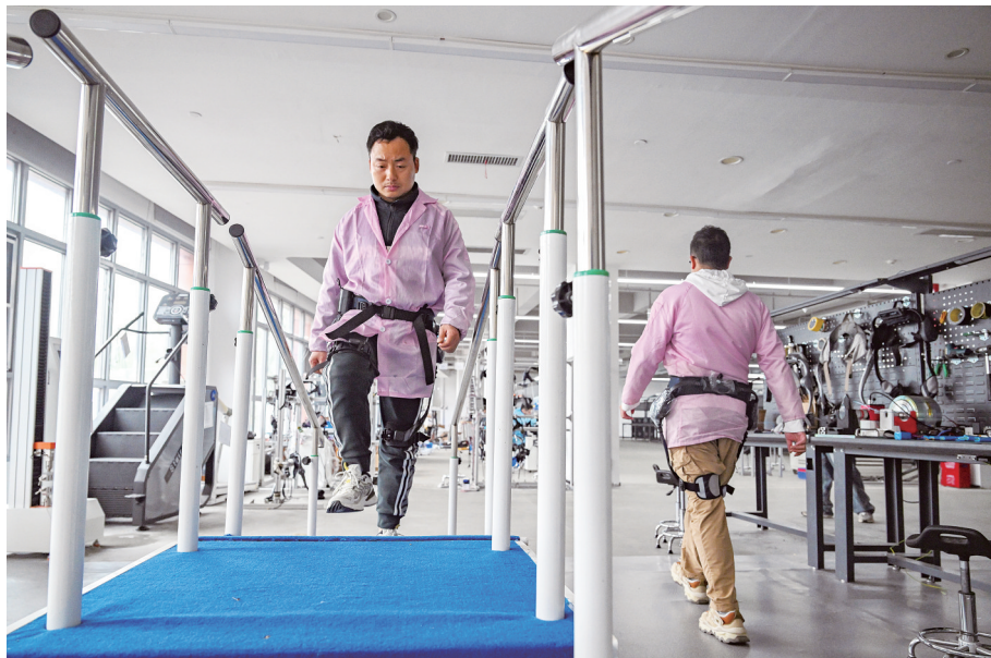
3月27日，长沙优龙机器人有限公司，技术人员穿戴AI运动助行外骨骼进行测试。
