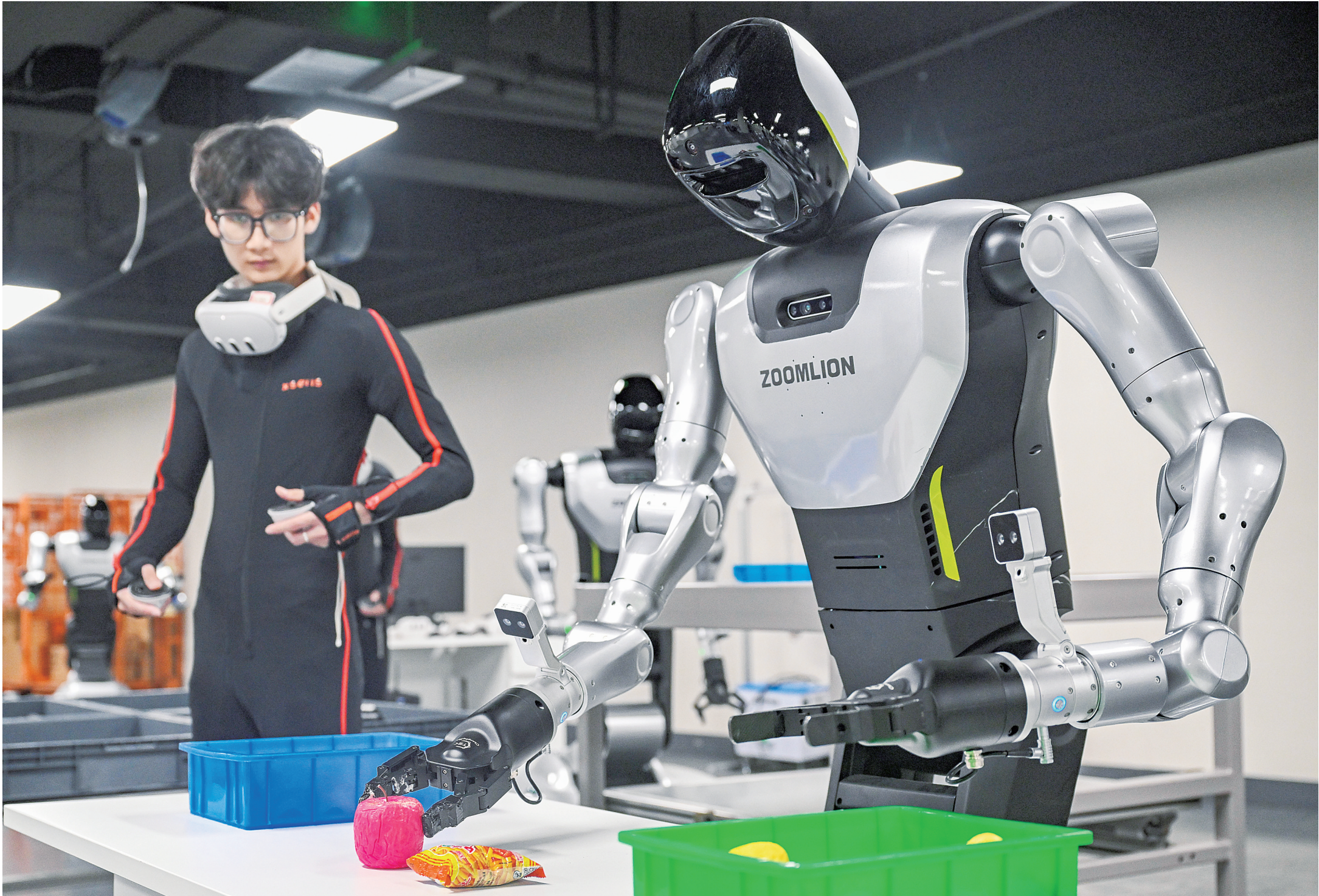
6月17日，中联重科具身智能人形机器人训练场，操作员通过手柄操控轮式人形机器人开展抓取、摆放物品等精细化动作训练，采集数据。
