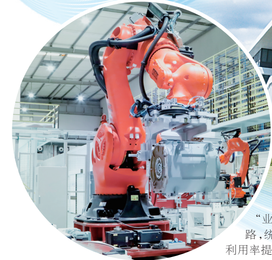
中车株洲电机公司牵引电机智能组装产线。
