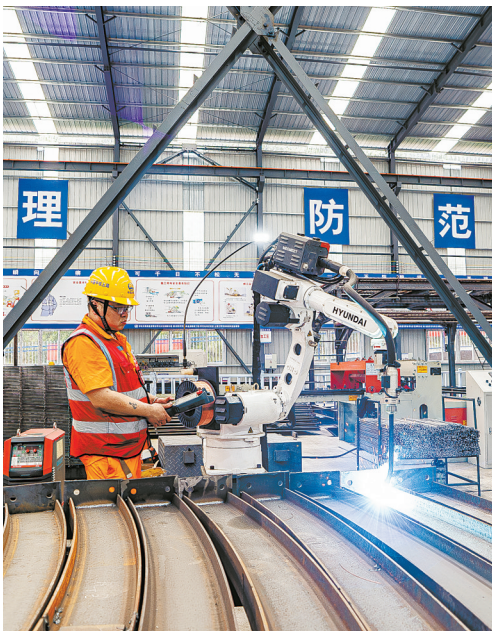
9月2日，长沙至浏阳市域(郊)铁路黄花机场至浏阳段工程(黄花机场至集里)土建工程第四标段钢结构加工中心，工作人员操控机器人开展钢拱架焊接作业。 湖南日报全媒体记者 童臻熙 摄
