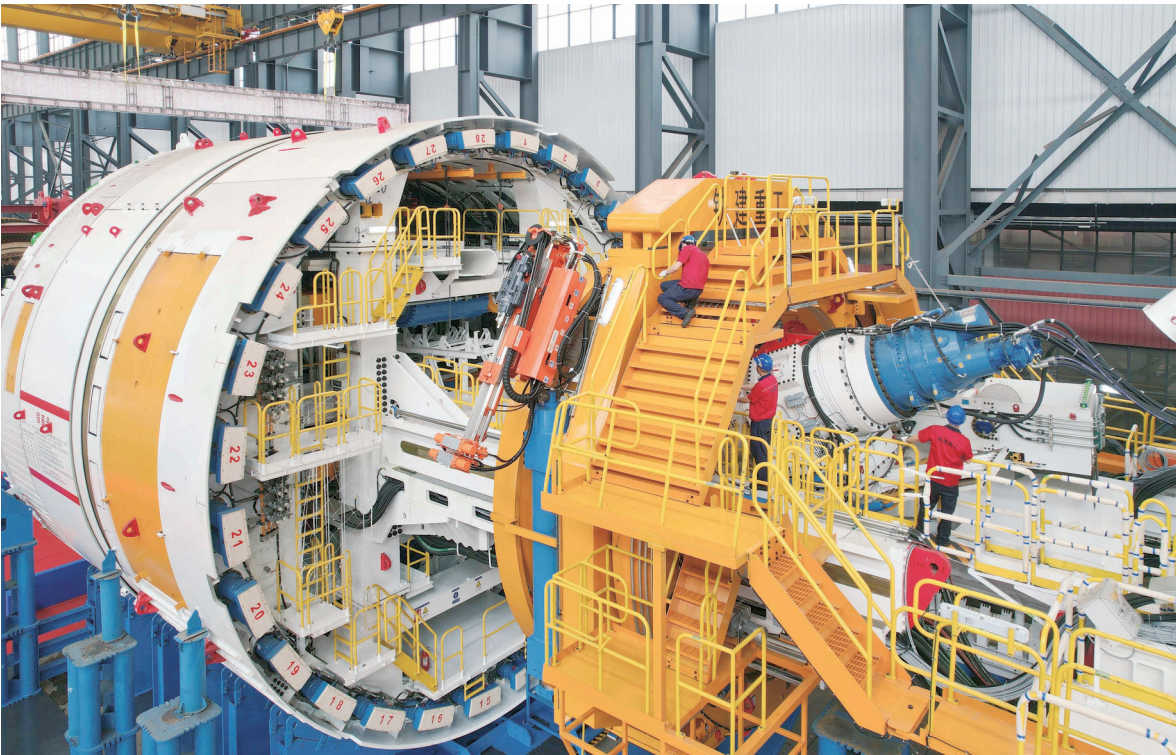
3月26日,由浙江省杭州市水务集团、铁建重工、中铁十八局等单位联合打造的全球最大直径土压平衡双护盾组合式隧道掘进机“强基号”在长沙顺利下线。“强基号”最大开挖直径达12.68米,总重量3500吨,未来主要承担位于浙江省杭州市的扩大杭嘉湖南排后续西部通道工程南段输水隧洞的掘进任务。湖南日报全媒体记者 辜鹏博 童迪 谢卓芳 摄影报道
