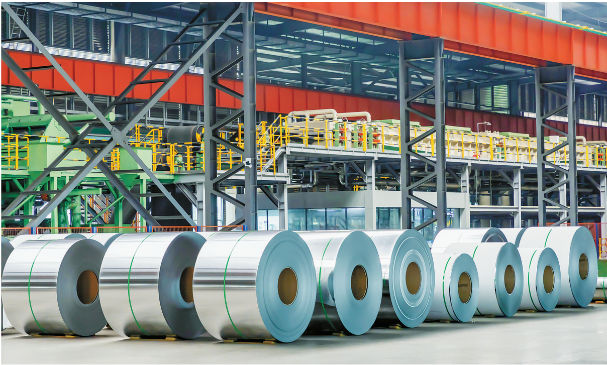
娄底市“材料谷”，由湖南宏旺新材料科技有限公司生产的硅钢卷产品，硅钢薄如纸片。 廖毅 摄（湖南图片库）
