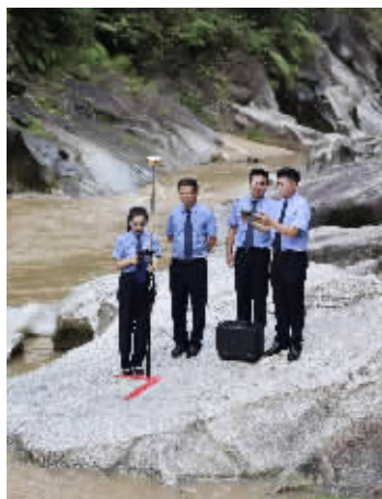
检察干警通过无人机进行倾斜影像采集，并使用RTK进行像控刺点提高建模精度。
